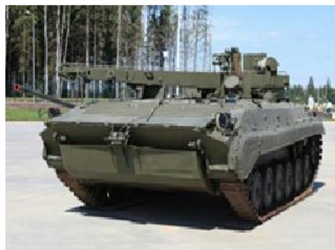
Как и у базовой машины, в моторно-трансмиссионном отделении БРЭМ-2 находится дизельный двигатель УТД-20 мощностью 300 л.с. Такая силовая установка обеспечивает удельную мощность на уровне 22 л.с. на тонну веса, благодаря чему скорость 14-тонной машины на шоссе достигает 65 км/ч. Имеется возможность пересечения водных преград вплавь при помощи перемотки гусениц. При этом скорость движения не превышает 6-7 км/ч.
