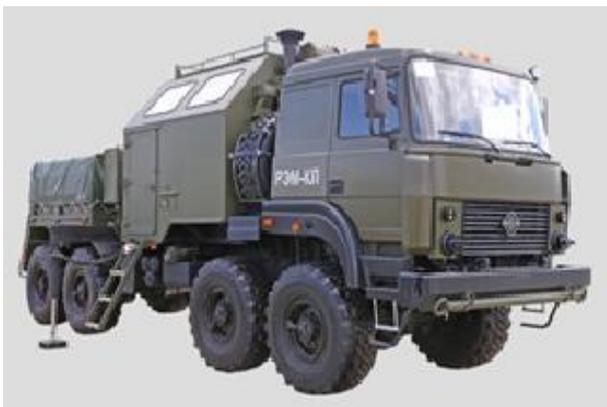
**4-рис.** РЭМ-КЛ - ремонтно-эвакуационная машина колесная легкая
