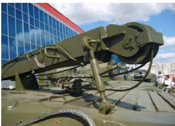
опорно-поворотное устройство крана. Эта система позволяет производить погрузочные работы в секторе шириной  $270^{\circ}$ . На опорно-поворотном устройстве крепится подъемная стрела с электромеханическими приводами. В походном положении стрела укладывается под углом к оси корпуса. При этом она ложится на специальную опору в средней части корпуса и фиксируется на своем месте при помощи растяжки с крюками.
